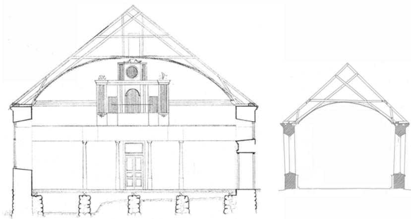
Figur 1.5 Till vänster en "Tegnérkyrka": Urshults kyrka, Kronobergs län (färdig 1810), inre bredd 18,8 m. Ritning ATA. Till höger medeltida kyrka ombyggd till "Tegnerkyrka" 1806: Morups kyrka, Hallands län, inre bredd 9,0 m. (Murverket är medeltida, takkonstruktionen sannolikt från 1806.) Uppmättningsritning av författaren.
