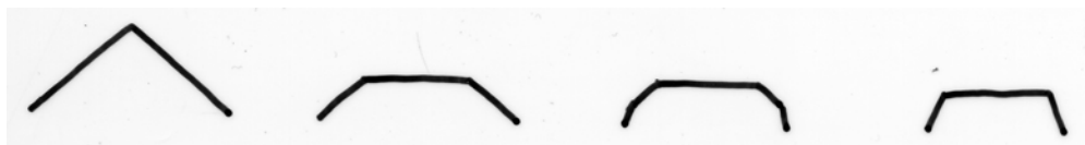
Figur 5.44 Bågformer som utgör unika styva kraftvägar i modellerna i fig. 5.43.
