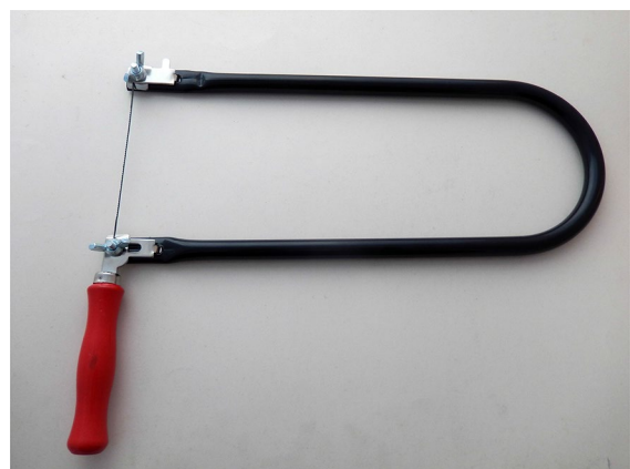
Fig. 2 A fret saw. Image: Gerd Fahrenhorst
