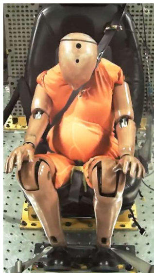
e) T-22259525 Produkt D: Bältesstoppare - Ingen större skillnad mot referens, men bältet ligger längre ut mot axel och överkroppen är mer vriden.
