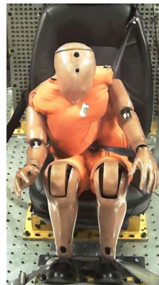
c) T-22259523 Produkt D: Bältesklämma - Bälte nedanför axel och över mage - Överkropp vriden över diagonalbälte
