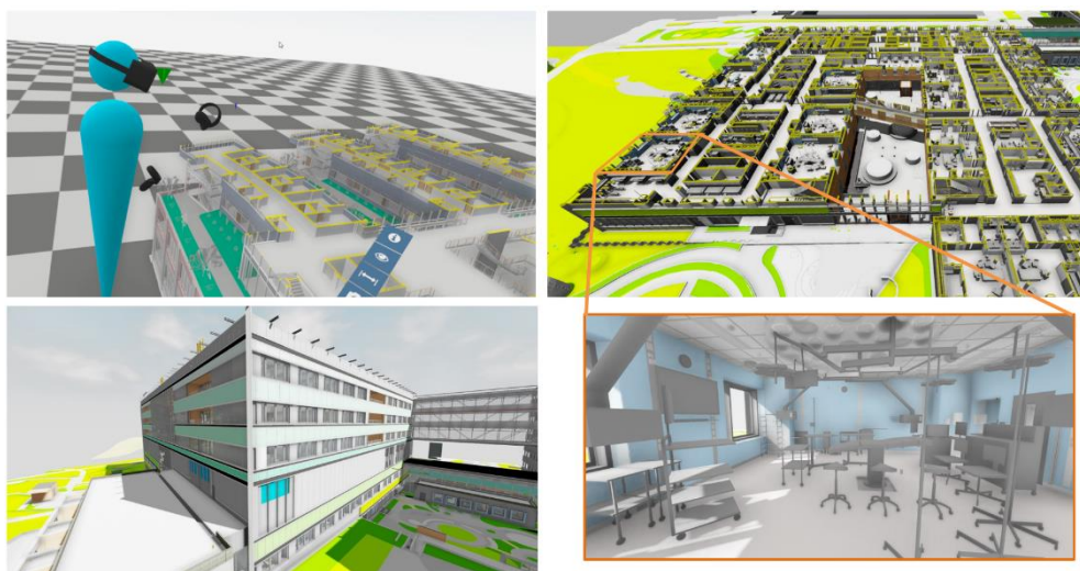
Figur 12: Användaren kan växla mellan en virtuell miniatyrmodell, skala 1:40, och skala 1:1 i VR-glasögonen.
