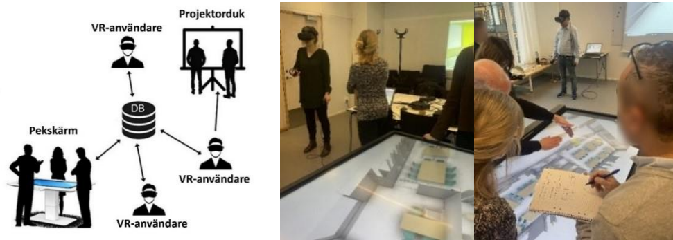
Figur 14. Användarna skapar ett virtuellt "mötes-rum" som är en databas som håller ordning på och skickar ut ändringar som gör av de olika användarna. Även de olika användarnas 3D-avatarer uppdateringar sköter databasen.
