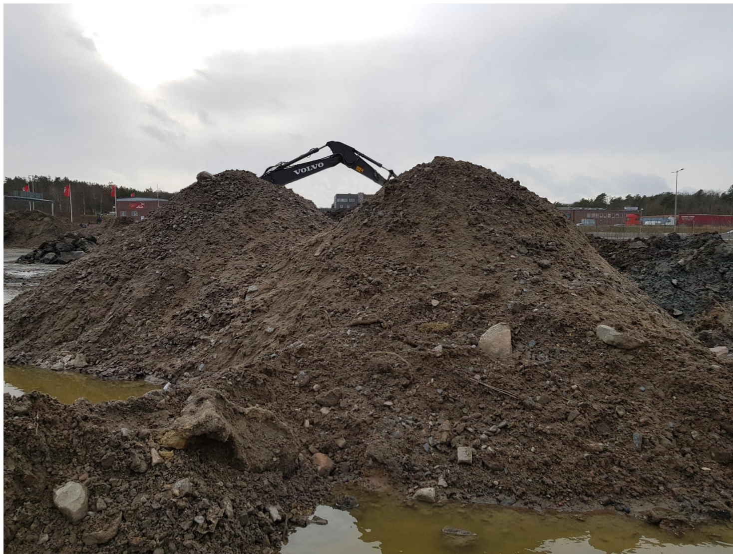
1.1.2 Foto 1: den provtagna högen inom projektet Cirkulär Masshantering. Mängd ca 180 ton. Jordart stenig sand.
