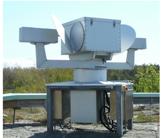
Fig. 4. The water vapour radiometer (WVR) Konrad.
