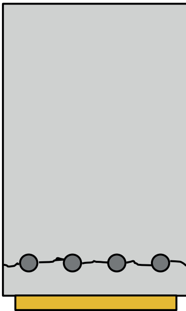
Figur 1: Laminat direkt pålimmat på ytan kan bli verkningslöst om korrosion ger sprickbildning som separerar täcksiktet från tvärsnittet.
