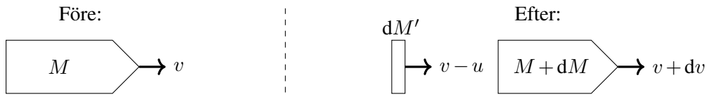
Figur 7.7: En schematisk bild av raketerna och dess bränsle vid olika tidpunkter, till vänster har vi en raket med massan M och hastigheten v . Till höger har vi samma raket en infinitesimal tid dt senare, med hastighet v + dv och massan M + dM samt en bit raketbränsle med massan dM' och hastigheten v - u .
