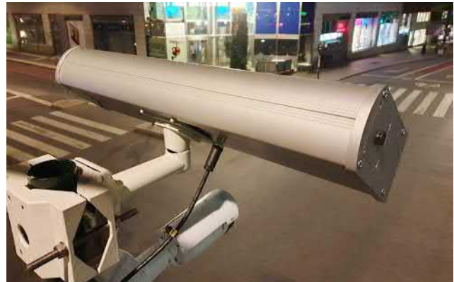
Multifunktionssensor med kamera som registrerar och räknar all typ av fordonstrafik - bilar, bussar, motorcyklar och cyklar. St Eriksgatan, Stockholm.
