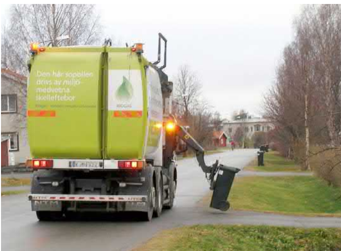
Sopbil med robotarm, Skellefteå.
