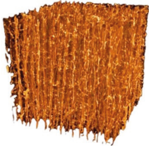
Bild: Datortomografibild på kolaerogel framställd ur lignin och cellulosa nanofibrer, visar den porösa strukturen i mikrometer storlek.
