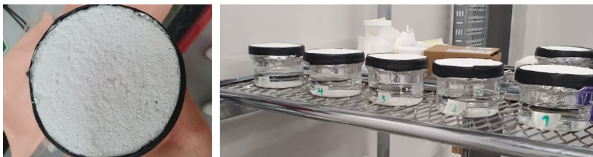
Figur 2. Tätning av prover med aerogelputs i koppförsök med epoxilim kombinerad med butylband och vulktejp.
