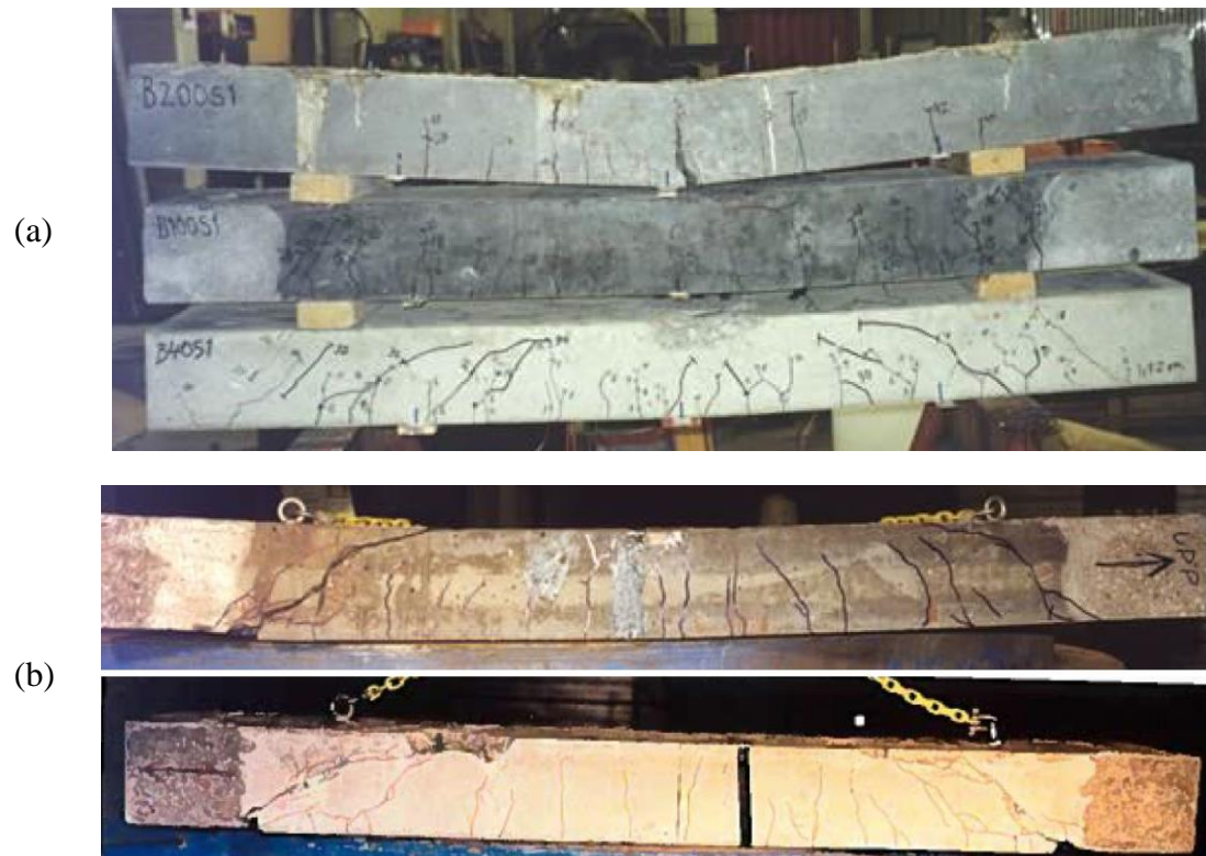
Figur 1.3 Foton av armerade betongbalkar utsatta för (a) statisk belastning (böjbrott) respektive (b) impulsbelastning (tvärkraftsbrott). Balkarna var identiskt utformade men med olika betonghållfasthet. Baserat på Hallgren och Balazs, (1999).
