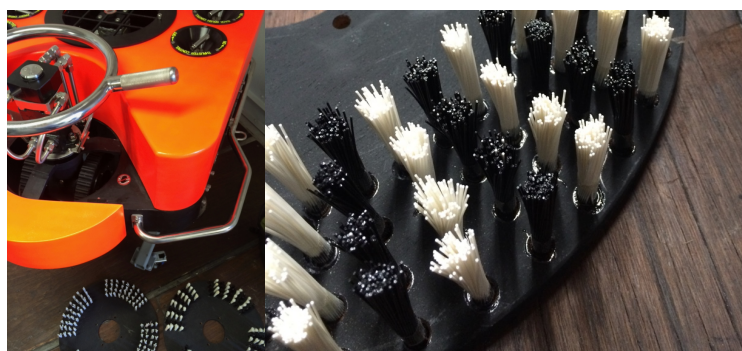
Figur 2. Exempel på rengöringsutrustning med borstar som opereras av dykare detaljbild av borstar till höger
