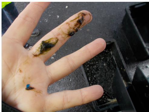
Figur 4. Algfärgflagor ca 10-20mm långa och färgflaga ca 3mm, i skrovrönsavfall från RoRo-fartyg som opererar i Östersjön
