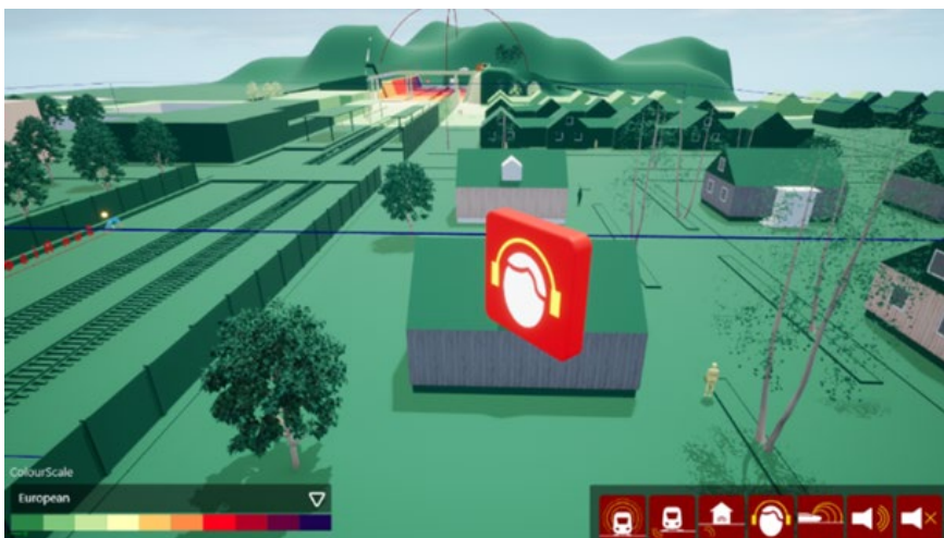
Figur 70. Flytande symboler som visas när du klickar på motsvarande symbol i gränssnittet. De tillhör inte 3D-modellen utan är en del av användargränssnittet och syns alltid i en storlek som är läsbar.
