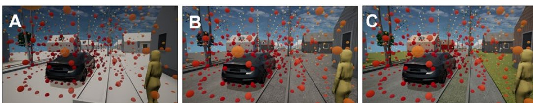
Figur 24A - C. Olika detaljeringsnivå på modellen undersöktes för att kunna definiera den nivå som ger bäst förståelse för själva bullervisualiseringen. Detaljeringsnivåerna som undersöktes var ofärgad (vit) modell utan texturer (A), gråskalig modell med texturer (B), fullfärgad modell med texturer (C).
