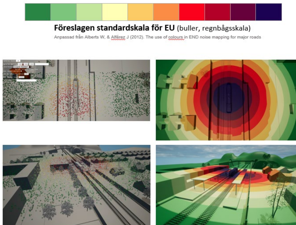
Figur 53. EU-standardskala (regnbågsskala) för buller, utvecklad och föreslagen av Alberts & Alferez (2012), här anpassad för 3D-modellen.
