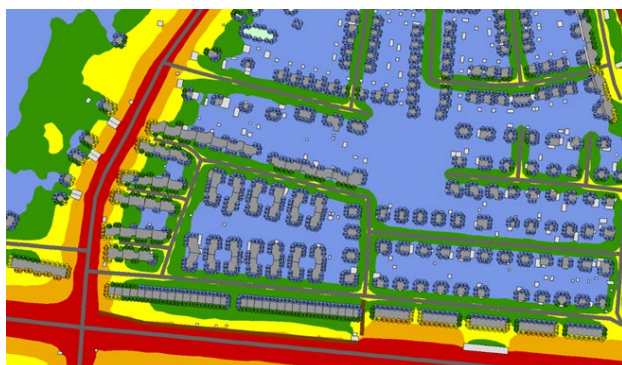
Figur 10. Exempel på användning av regnbågsskala för att visualisera buller i 2D. (Stahre Wästberg et al, 2020)
