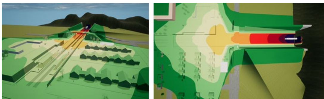
Figur 74. Konceptuell visualisering av tunnelknall i fågelperspektiv (vänster) och top-downperspektiv (höger), representerad som en draperad heatmap med den föreslagna standardskalan för buller inom EU (se figur 60).
