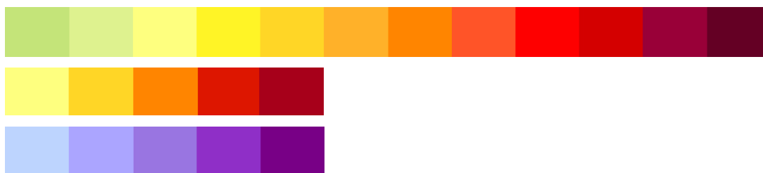
Figur 91. Exempel på tre färgskalor med två olika fingradighet: den översta skalan utgår från skala A, där vi har ökat antalet steg, samt ändrat ändfärgerna. Den mittersta skalan är en förkortad version av skala C, där vi har ökat kontrasten mellan stegen. Dessa båda skalor är anpassade för röd-gröna färgdefekter på så sätt att de har ökad färgmättnad och minskad ljushet. Den understa skalan visar ett alternativ som undviker röda och gröna färger. Skalan bygger på användarresultat för skala D, där den blå färgen uppskattades av personer med färgdefekt seende. Här har vi istället valt färgen lila som inte associerar lika tydligt till vatten för normalseende.
