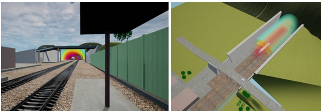
Figur 76. Konceptuell visualisering i sandlådemodellen av elektromagnetiska fält, representerad som tredimensionell heatmap, med "Trafikverket-skalan".
