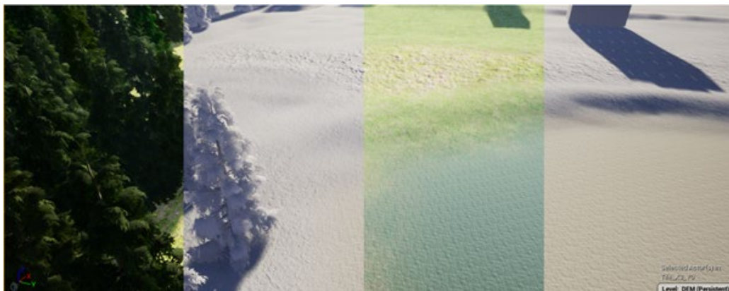
Figur 85. Sammansättning av materiallagerinformation i 3D-modellen i Unreal Engine. Unreal Engine erbjuder en "Landscape Layer Blend"-nod i materialredigeraren. Noden gör att vi kan blanda flera texturer och material kopplade till landskapsmaskerna. Ett lager läggs till för varje klass och tilldelas en struktur. Genom att kombinera flera lager kan man lägga till ytterligare detaljer i geometrin utan att öka 3D-modellens komplexitet. Detta görs genom att lägga på specifika texturer som informerar Unreal Engine om hur ljus interagerar med dessa material. Figur 85 visar en enda scen från den slutliga modellen som har färgerna på eller av alternativt. I de sektioner där färgerna är avstängda ser vi fina detaljer på marken som varierar beroende på landskapsklass. Dessa detaljer skapas med hjälp av "bump-" och "displacement-"texturer som innehåller information om hur den släta ytan ska förvrängas för att ge modellen ett mer realistiskt utseende utan att behöva ytterligare polygoner.
