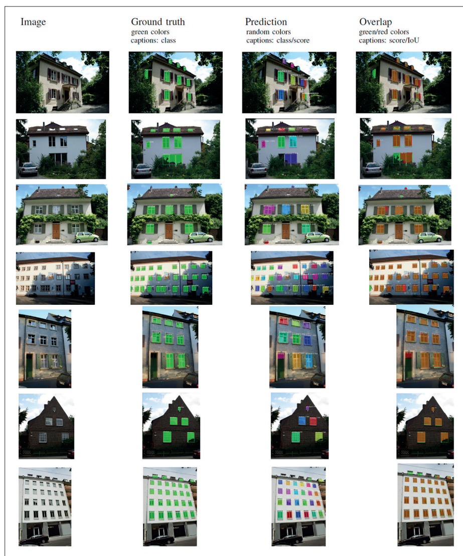
Figur 5: Resultat från fasadsegmenteringen med hjälp av Mask R-CNN modellen. Den vänstra kolumnen visar originalbilderna, den andra vänstra kolumnen visar de manuellt taggade bilderna (ground truth), den tredje kolumnen visar algoritmnernas prediktion och den fjärde kolumnen visar överlappningen mellan "ground truth" och prediktion. Matchande fönster är markerade i orange.
