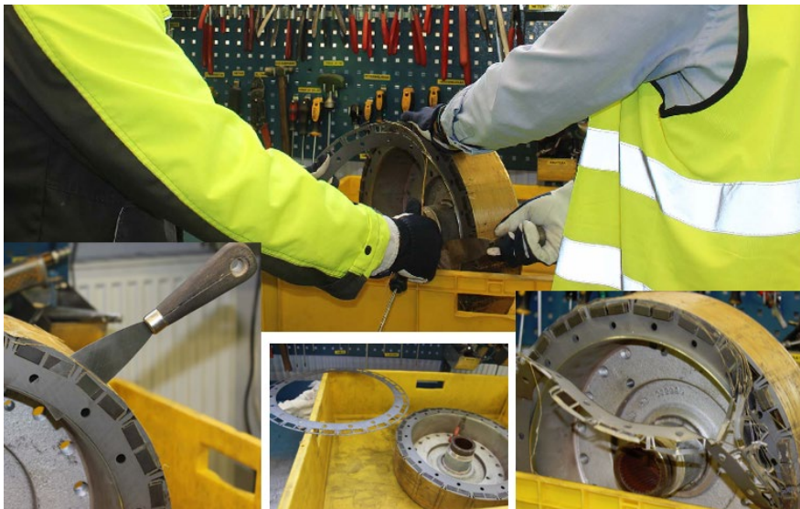
Figur 5.21: Rotorlaminaten plockas bort en i taget med skruvmejsel och spatel (bildserie).
