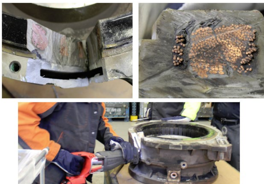
Figur 5.23: Försök att se lindningen gjordes genom att såga genom isolermaterialet (bildserie).
