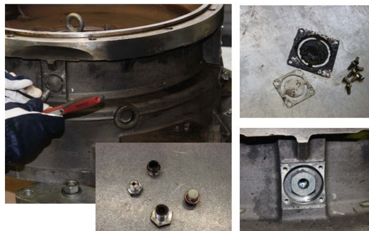
Figur 5.14: Två kvadratiska brickor, åtta skruvar och två ventilbultar lossas med en skruvnyckel. Av två kylkanalbultar så är en i metall och en i plast (bildserie).
