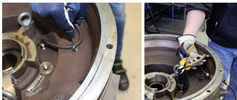
Figur 5.12: Resoversladden lossas och klipps av (bildserie).
