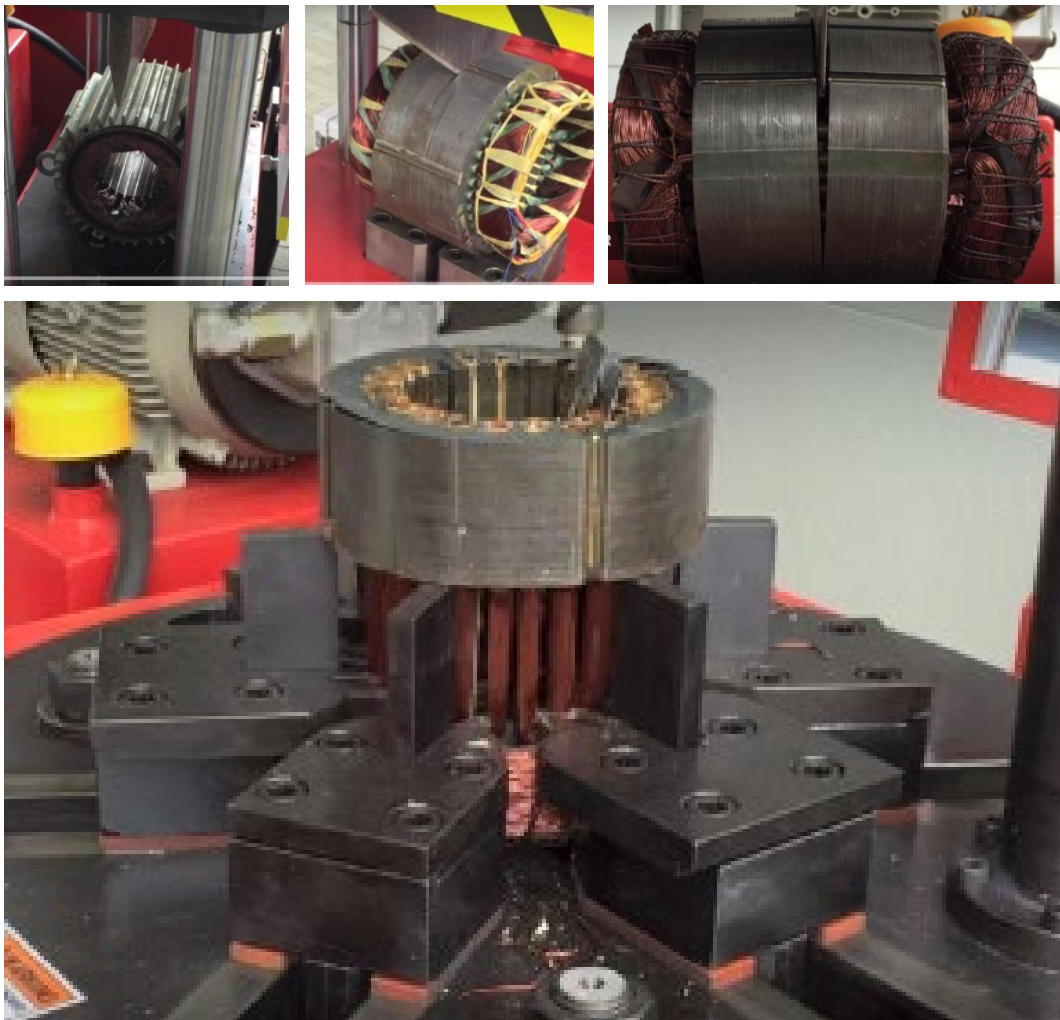
Figur 7.1: Exempel på en klyv och dragmaskin som kan användas för att separera statorn i renare materialfraktioner (bildserie) Maskinen på bilderna kommer från Bronneberg BV och marknadsförs som en "electric motor recycling machine". (Bilder återgivna med tillstånd)
