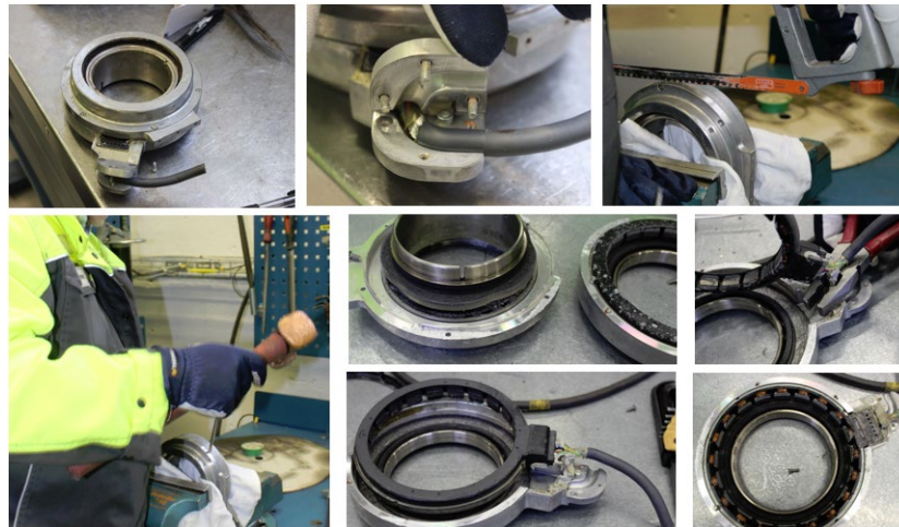
Figur 5.19: Resolvern och lager plockas isär med hjälp av såg, stämjärn, slägga och tång
