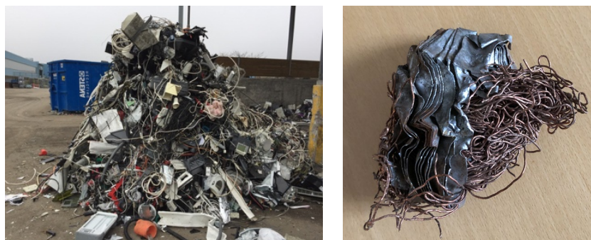
Figur 6.2: Skrot på väg in i hammarkvarnen (till vänster) samt fragmenteringsrest från en elmotor, en så kallad ”köttbulle” (till höger).
