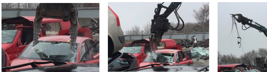
Figur 6.1: Demontering av vindruta och kablage ur skrotbil inför fragmentering
