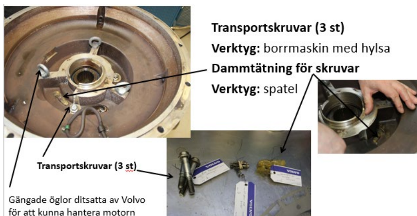
Figur 5.11: Det var omständligt att värma bort fixeringsmassa för att få loss skruvarna, en av skruvarnas huvud blev lite deformerad och bitsen fick hamras ner (bildserie).
