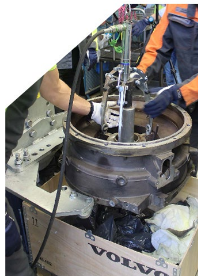
Figur 5.15: Rotorn pressas ut från stator och hus.
