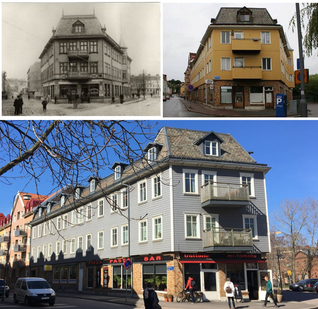
Figur 14a-c: Fastighet B under olika årtionden. Figur 14a: Överst till vänster: Så som byggnad B såg ut 1915 före tillbyggnaden. Foto: Göteborgs stadsmuseum. Figur 14b Överst till höger: Byggnad B efter tilläggsisolering och ny fasad i plåt på 1970-talet. Foto: Jesper Hallén. Figur 14c nederst: Byggnad B efter den senaste om-renoveringen då träfasaden har återskapats. Foto: författarna. 2017
