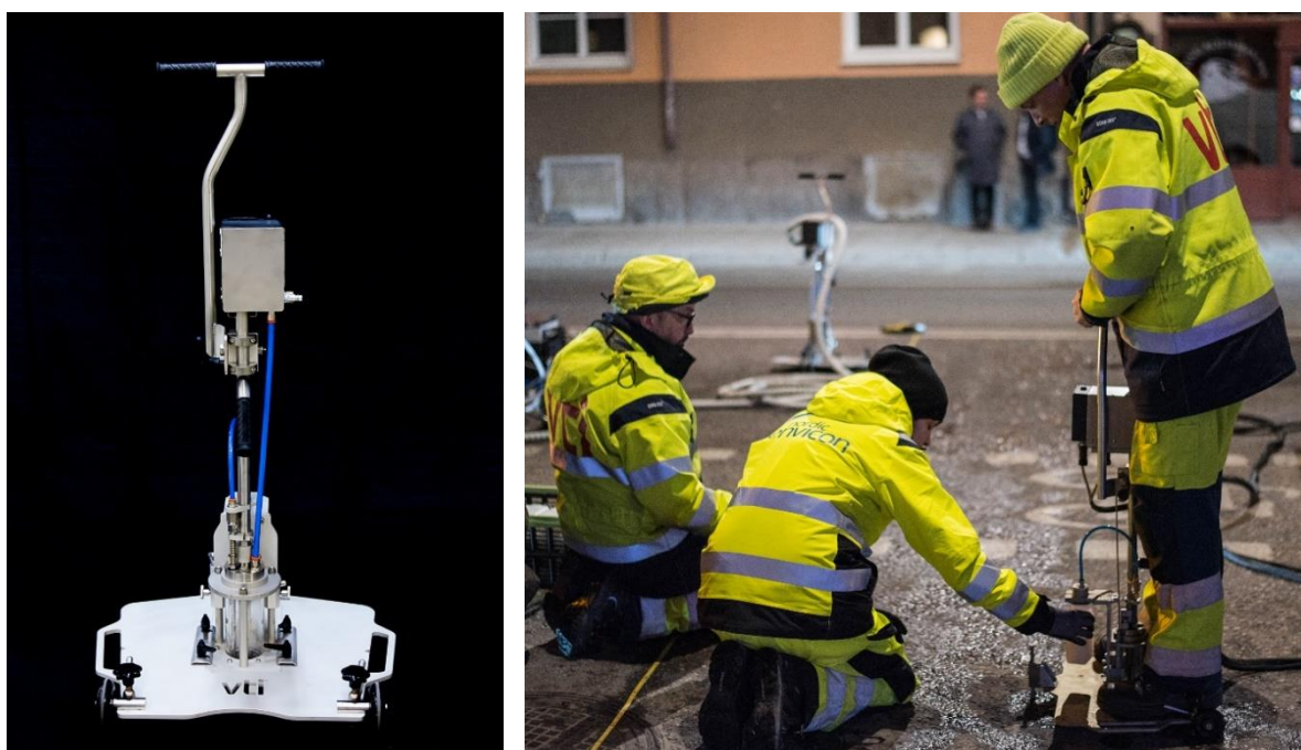
Figur 11. Wet Dust Sampler (WDSII), provtagningsenhet och provtagning i fält. Foto: Mats Gustafsson, VTI och Sami Kulovuori, Metropolia.
