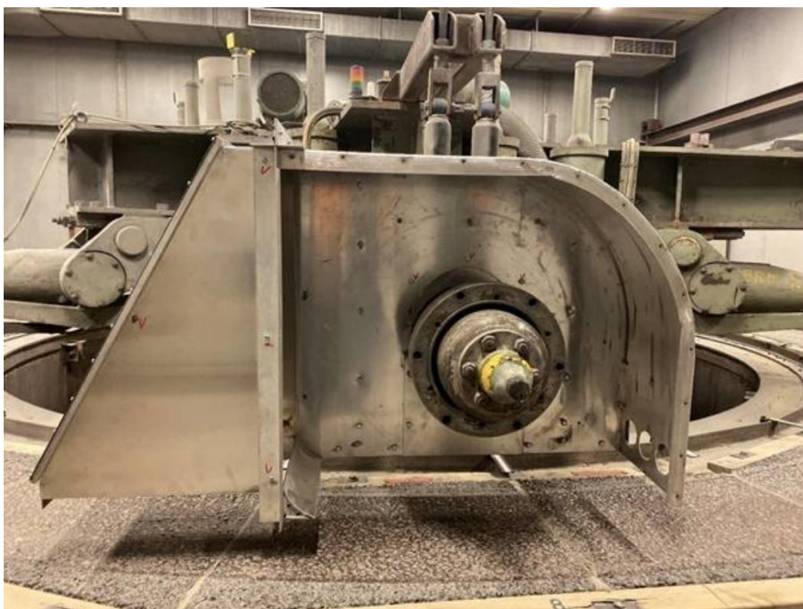
Figur 9. Huv till VTI:s provvägsmaskin för insamling av slitagepartiklar från däck och vägbeläggning till dammsugare. Foto: Mats Gustafsson, VTI.
