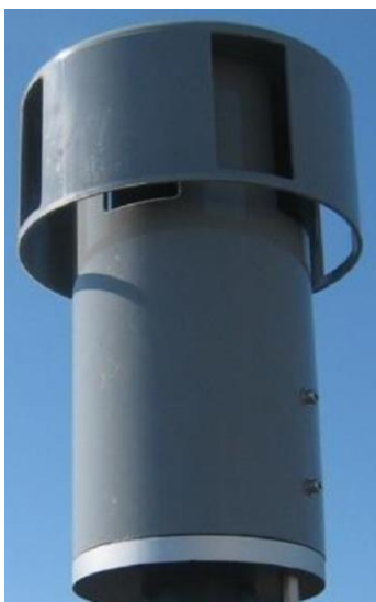
Figur 15. Sigma-2 passiv provtagare för luftburna partiklar. Foto: Particle Vision.
