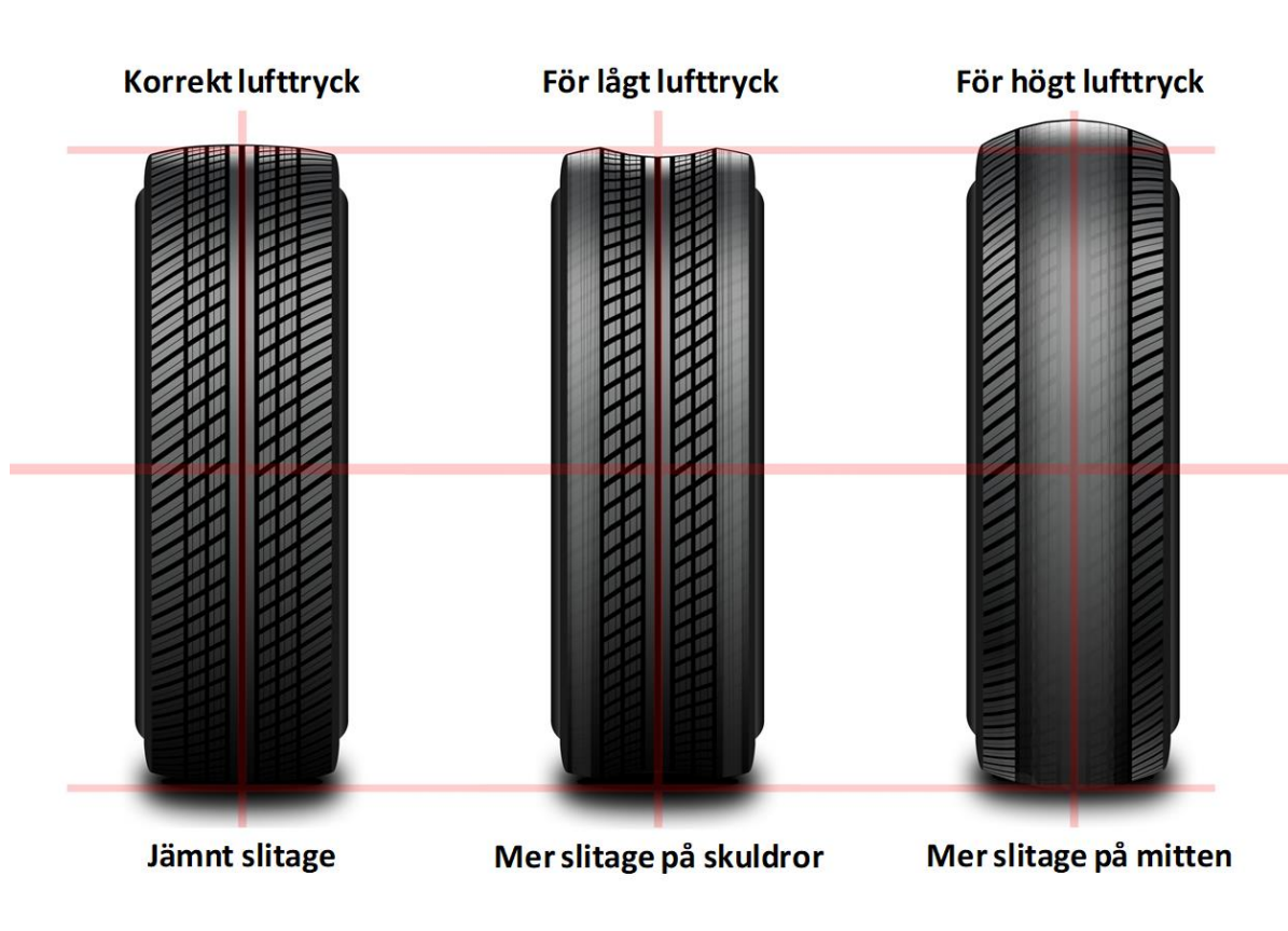
Figur 3. Effekt på slitage över slitbanan av olika däcktryck. Källa: Jaco Superiors Products 7 .
