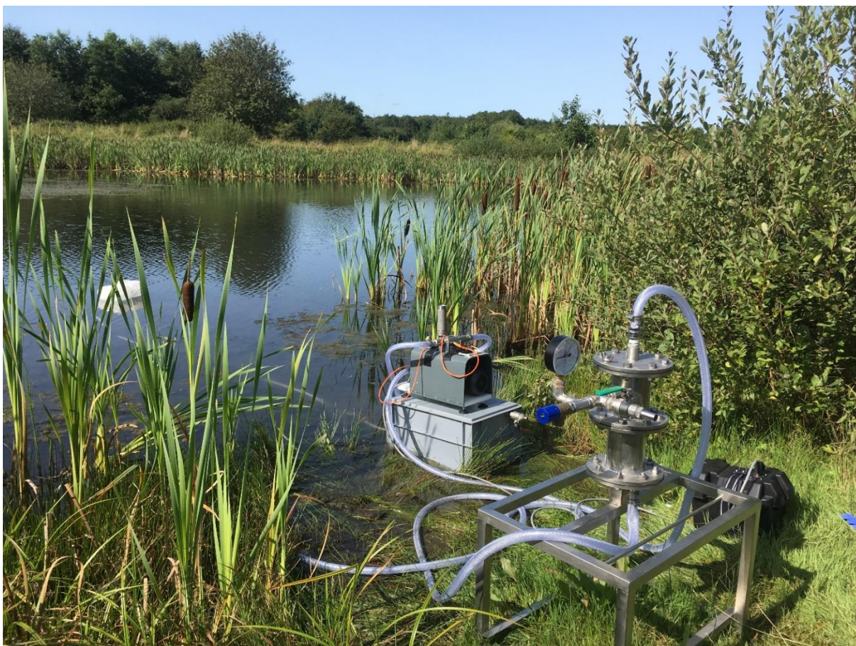
Figur 19. Utrustning för provtagning av vatten i dagvattendamm. Foto från Liu m.fl. (2019).
