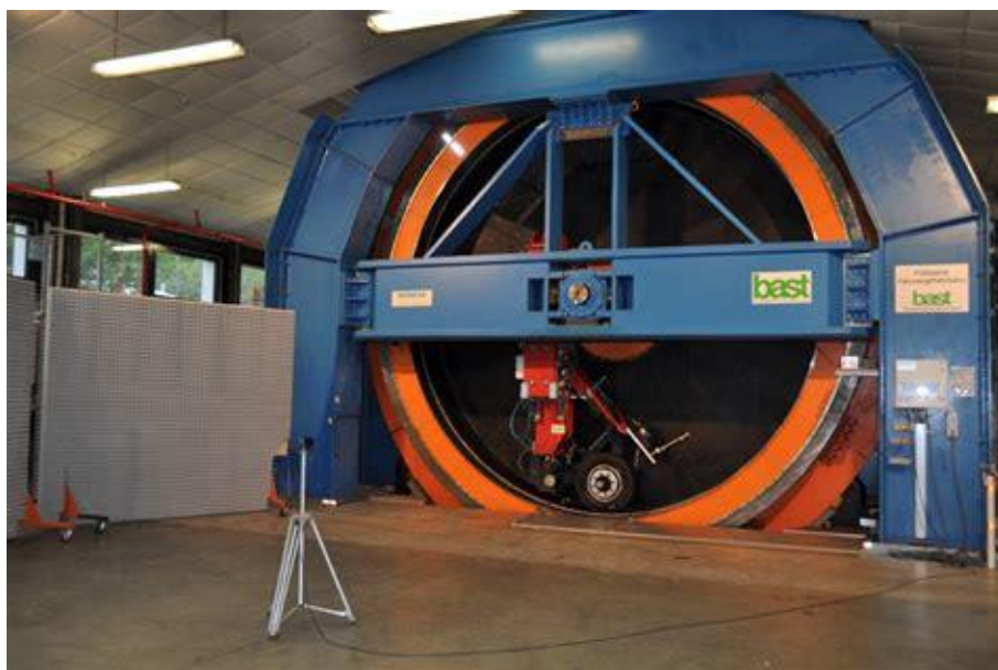
Figur 7. Vertikala trummor för test av däck mot vägbeläggning. BAST (Bundesanstalt für Straßenwesen) Tyskland. Foto: Re-tyre project, EU.
