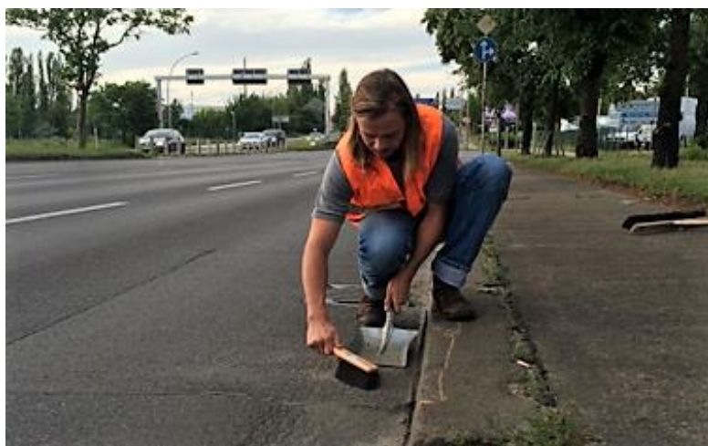
Figur 14. Provtagning av vägdamm med borste och skyffel. Foto: Technische Universität Berlin, 2019.
