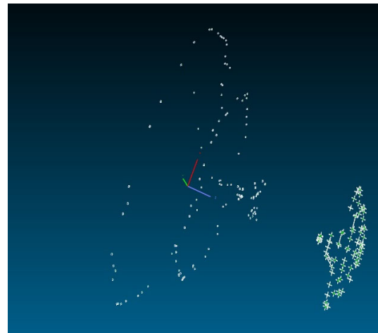
Abb. 6: Geplante (links) und tatsächlich geflogene Aufnahmeconfiguration für eine Elevationsposition
