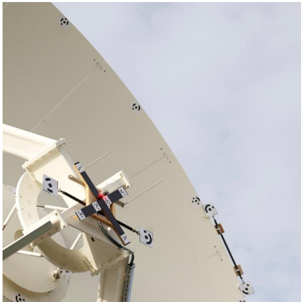
Abb. 3: Positionen der Zielmarken auf der Antennenoberfläche, dem Subreflektor sowie an den Enden der kalibrierten Kohlefaserstäbe und dem Koordinatenkreuz am Subreflektor.
