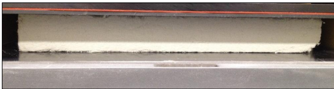
Figure 12: Rigid APM board installed in the heat flow meter apparatus without insulation at the edge. Source: Deutsches Zentrum für Luft- und Raumfahrt.
