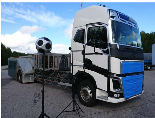
Figur 2. Provobjektet (här utan spegel monterad). Drivlinan är i bak på fordonet. Hytten är tejpad för att undvika övriga vindbruskällor förutom speglarna. Vindmätaren sitter på stangen som sticker upp från hytten. Högtalaren används här för att testa ljudreduktion genom dörren (inte del av standardtestet).
