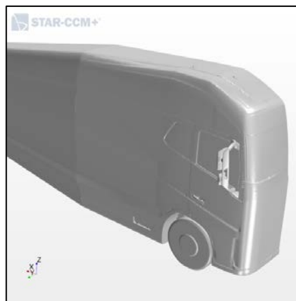
Figur 7. Förenklad lastbilsmodell för simuleringar.
