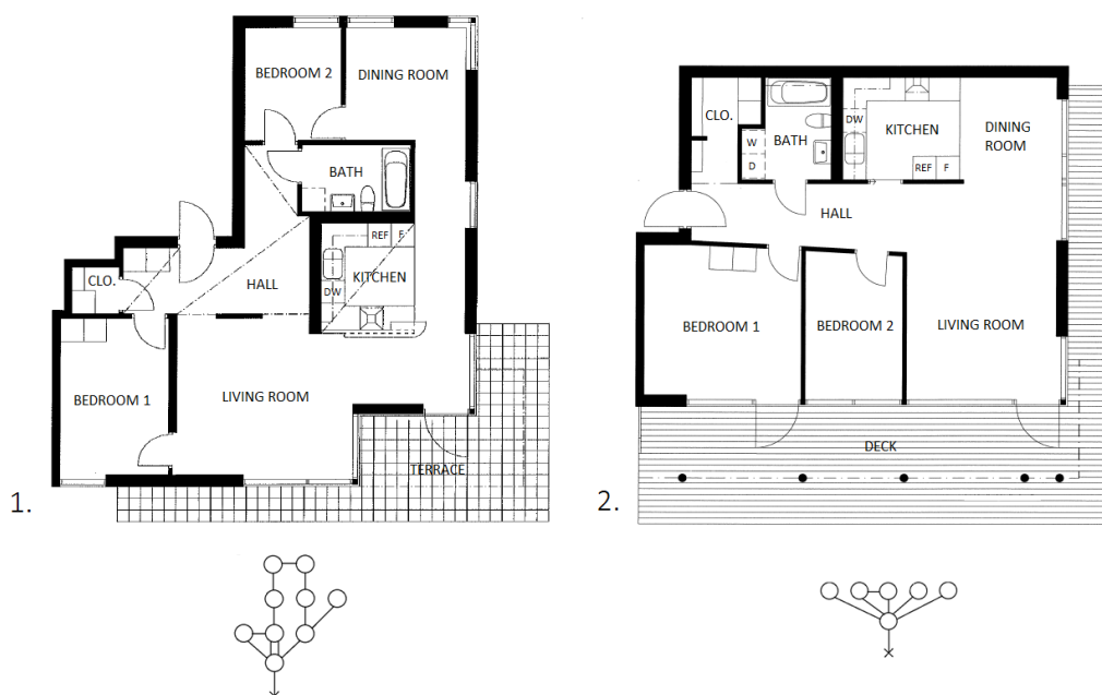
Figur 1a och 1b: 1a (vänster) en över-fraktionerad lägenhet och 1b (höger) en under-fraktionerad. Under varje figur syns bostadens uppbyggnad tolkad som rumsligheter enligt space syntax (Bafna, 2003).
