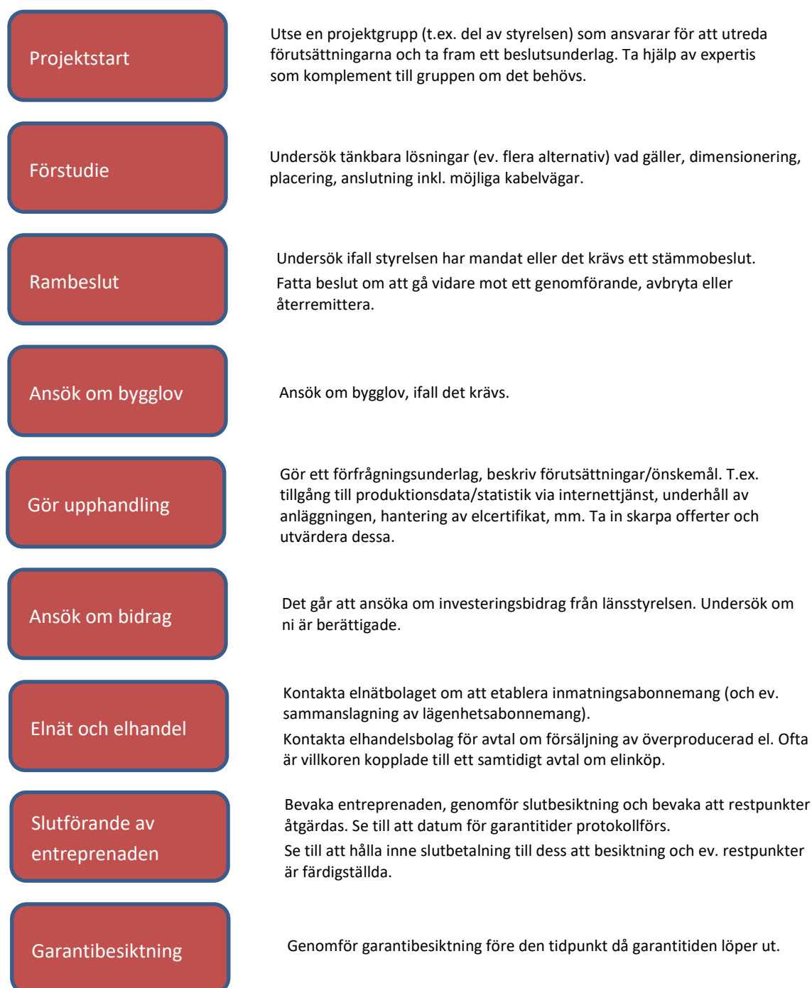
Figur 1. Processteg för installation av solceller utifrån ett beställarperspektiv. Baserad på Sommerfeldt et al. (2016, sid. 29 - 30).
