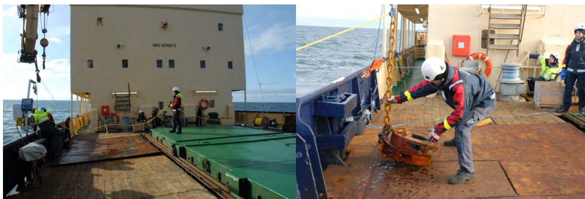
Figur 23 Sjösetting av ROV från R/V Balticas arbetsdäck: t.v. fartygskranen används för att lyfta i ROV:n, t.h. en tyngd hängande i kranvadjern används för att ROV:n inte skall driva iväg med strömmen och få ROV-kabeln att hänga så lodrätt som möjligt från fartyget mot botten.
