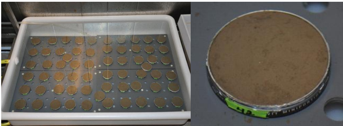
Figur 6. Experimentuppställning under in situ liknande förhållanden vid Sven Lovén Centrum för marina vetenskaper. Till höger sedimentpluggen i naturlig storlek.
